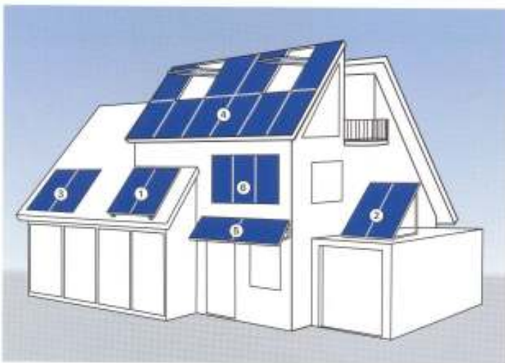
Způsoby montáže velkoplošných FV-modulů řady Premium-Linie
